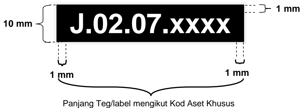
Rajah 35 : Contoh Ukuran Teg/label Komponen (Lampu Jalan)
